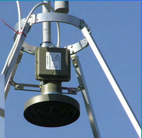
C-Band 4GHz konvertor
