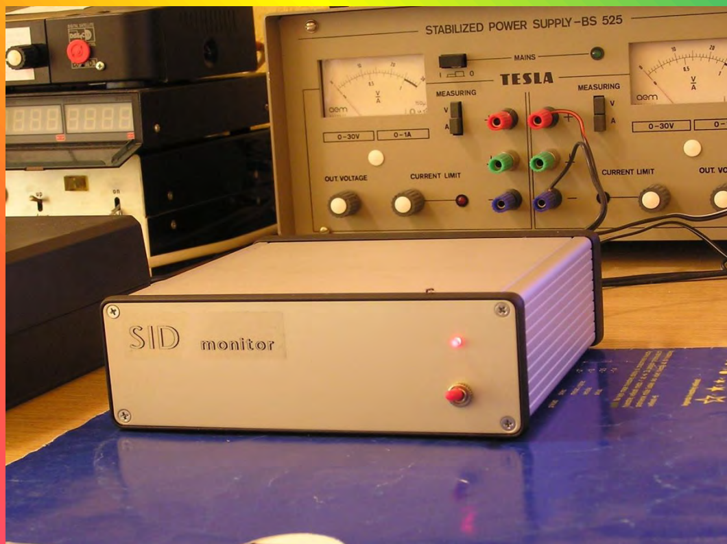
SID monitor – jednokanálový přijímač VLF 12bit A/D konvertor
