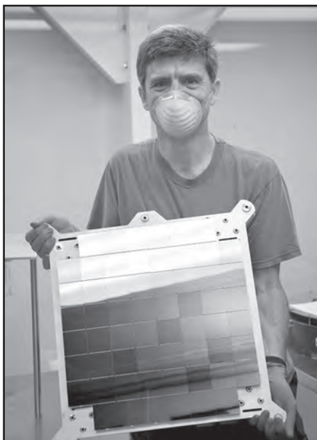
Obrázek 2: Najväčšia CCD kamera na svete – 1,4 miliárd pixelov a rozmer 40×40 cm, v rukách Johna Tonryho, jedného z tvorcov kamery. John Tonry bol v kolektíve, ktorý v roku 2011 získal Nobelovu cenu za fyziku za rozpínanie vesmíru.
