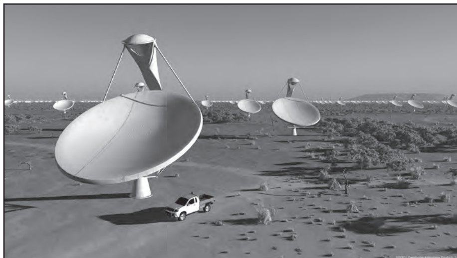
Obrázek 7: Umělecká představa systému antén o rozměrech 15 x 12 m v centru systému SKA. Poděkování: Swinburne Astronomy Productions for SKA Project Development Office.
